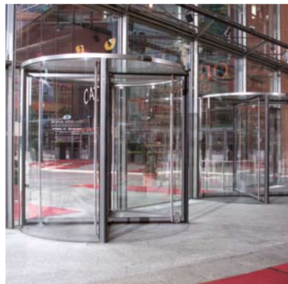
Diseño íntegramente en cristal con unidad motriz en subsuelo
