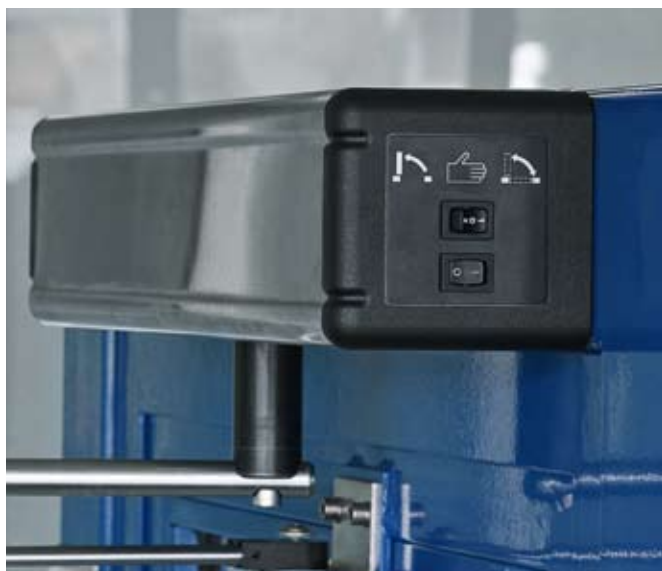
Selector de programas "automático/manual/abierto" integrado en la unidad FDC.
